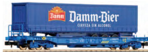
Vagón portacontenedores tipo Sddkkms con una caja móvil de 40 pies Damm Bier. Longitud 102 mm.
