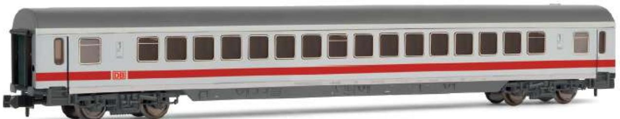
*Die Großraumwagen der Bauart Apmz 125 sind modernisierte Apmz121 und wurden in den sechziger Jahren gebaut. Die Fahrzeuge liefen vorher u.a. im legendären TEE-„Rheingold“ und in verschiedenen anderen TEE-Zügen sowie im IC `79-Programm der Bundesbahn. Bei der DB AG werden sie im hochwertigen IC-Verkehr eingesetzt.*
