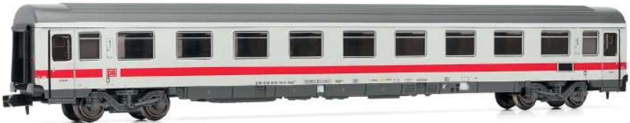
*Die bei der DB AG als Avmz 108.7 eingereichten Abteilwagen sind modernisierte, 1977/78 von LHB in Salzgitter als Avmz 207 für den TEE-Verkehr gebaute Reisezugwagen nach Eurofima-Bauart und mit Schwenkschiebetüren und Klimaanlage. Bei der DB AG werden sie im hochwertigen IC-Verkehr eingesetzt.*
